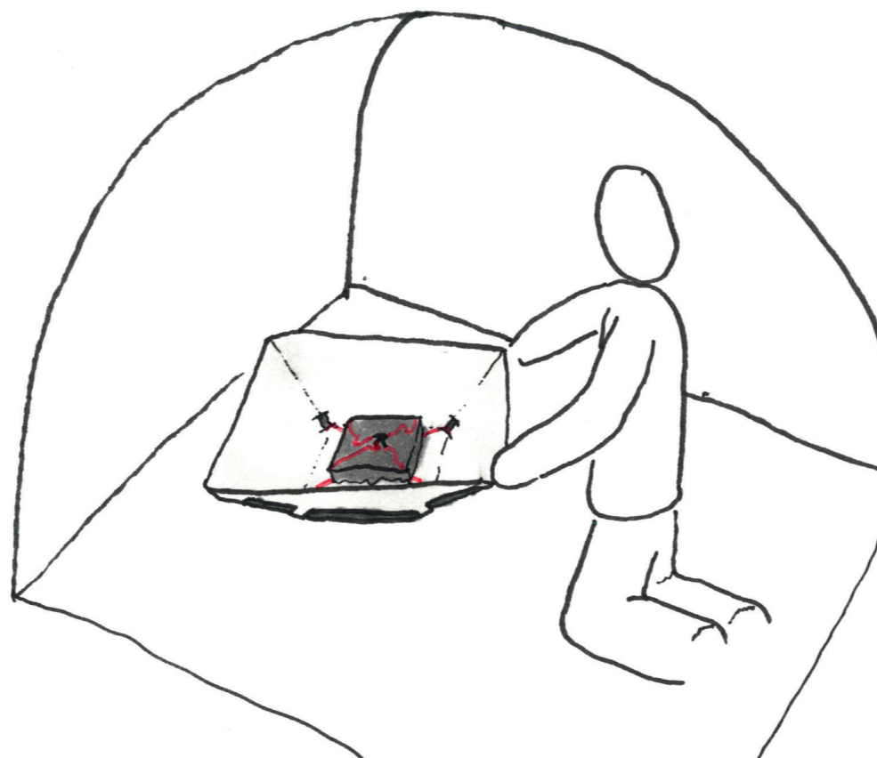
Step 2: Lampen folder sig selv ud. Pga: • Lampeskærmen er lavet af rispapir coated med recycled polyester. Dette materiale vil automatisk folde sig selv ud. • Stellet er lavet er plastic som også helst vil folde sig ud i udstrækt position. (se side x, for mere info)
