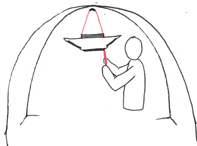
Step 3: Lampens højde justeres ved at trække i en snor.
